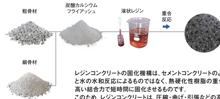
レジンコンクリートの固化機構は、セメントコンクリートのようにセメントと水の水和反応によるものではなく、熱硬化性樹脂の重合反応により高い結合力で短時間に固化させるものです。このため、レジンコンクリートは、圧縮・曲げ・引張などの高強度特性を有するほか、耐食性・水密性・耐摩耗性・遮塩性に優れた多機能な材料です。
