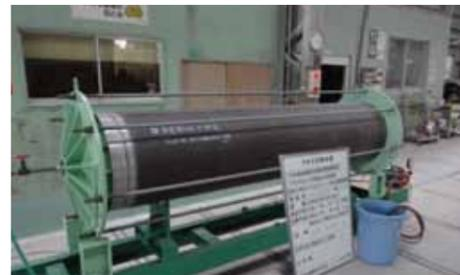
内水圧試験状況写真 小口径管
