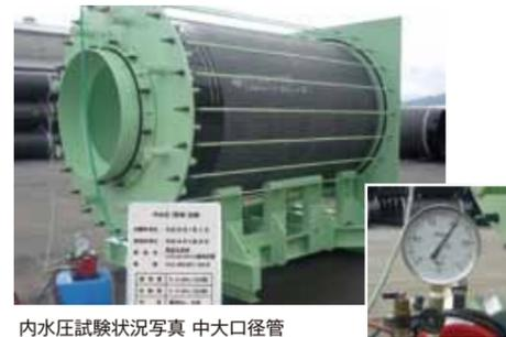
内水圧試験状況写真 中大口径管
