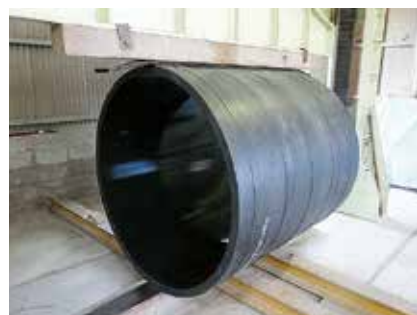
側方曲げ強さ試験
