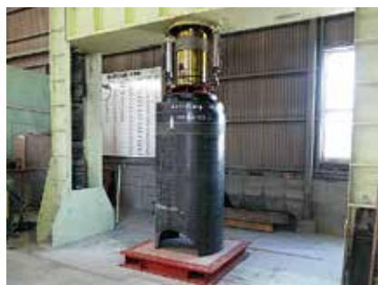
軸方向耐圧強さ試験
